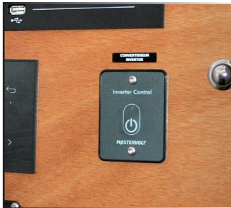
INTERRUPTOR DEL CONVERTIDOR
