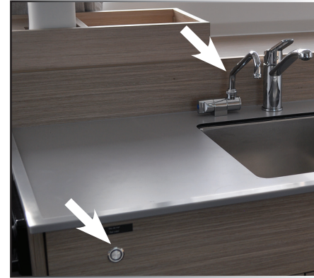
GRIFO DE AGUA DE MAR + INTERRUPTOR DE BOMBA DE AGUA DE MAR
