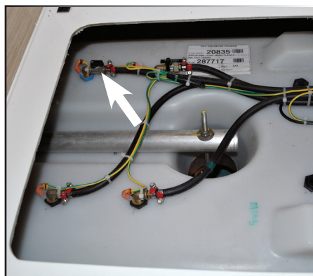
VÁLVULAS DE CARBURANTE
