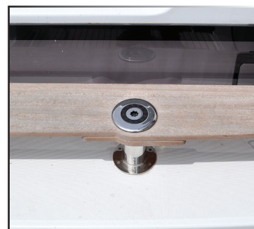
IMBORNAL DE CAÑA DE EMERGENCIA
