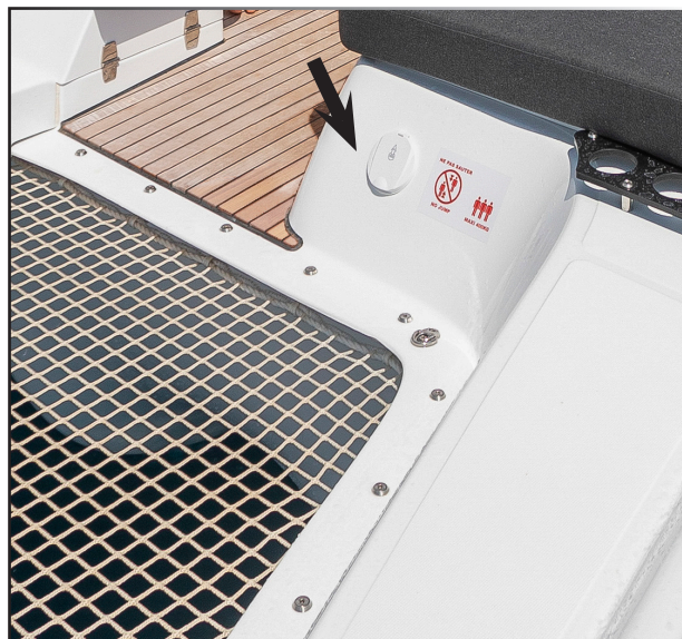
CONEXIÓN BOMBA DE LAVADO DE CUBIERTA
