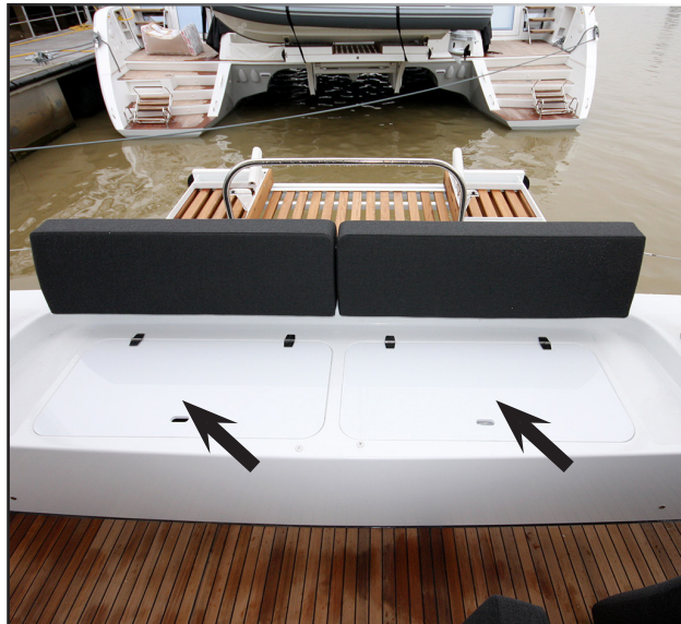
EMPLAZAMIENTOS DE LAS BALSAS SALVAVIDAS
