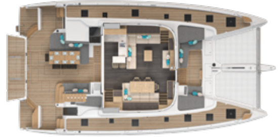
Salon & cockpit galley down / Carré & cockpit cuisine en bas
