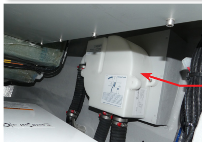
Séparateur Échappement Générateur
