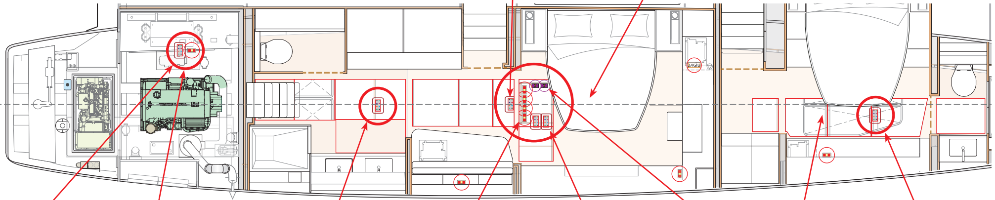
Bloc Fusibles Tribord X82 Salle Moteur
