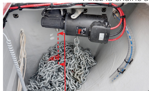
Laissez un espace libre d'au moins 40 cm entre le tube de la chaîne et le monticule de chaîne.
