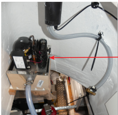
Compresseur 24V Glacière (Accès via S/M)
