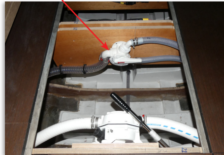
Pompe Aspiration Eaux Grises SdB Propriétaire (vers Vanne 3 Voies) Passe-coque & Vanne Rejet Mer Réservoir Arrière Vanne de Sélection 3 Voies SdB Propriétaire (Mer ou Réservoir) Nable de Vidange Réservoir Arrière via Station de Pompage Évén Réservoir Avant Nable de Vidange Réservoir Avant via Station de Pompage Pompe 24V Rejet Mer Réservoir Avant Vanne de Sélection 3 Voies Cabines Avant (Mer ou Réservoir) Pompe Aspiration Eaux Grises VIP (vers Vanne 3 Voies)
