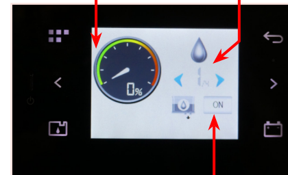
Niveau Réservoir Eaux Grises 1
