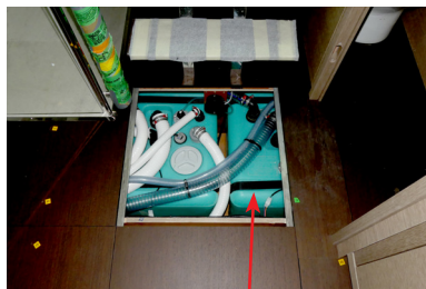
Réservoir Arrière Eaux Grises : 120 litres
