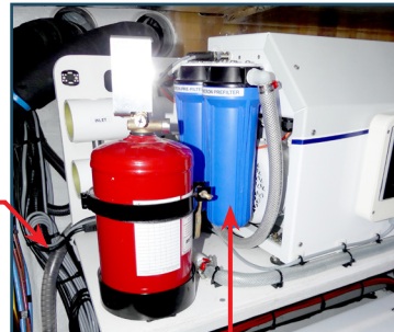
Tuyau de Rejet à la Mer de la Saumure
