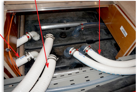
Pompe 24V Décharge à la Mer Réservoir Arrière Vanne Passe-coque Réservoir Arrière Pompe Manuelle de Secours Réservoir Arrière Nable de Vidange Réservoir Arrière via Station de Pompage Évén Réservoir Avant Tuyau de Vidange Réservoir Arrière via Station de Pompage Tuyaux d'Aspiration Pompes Réservoirs Avants Pompe 24V Décharge à la Mer Réservoir Avant Pompe Manuelle de Secours Réservoir Avant
