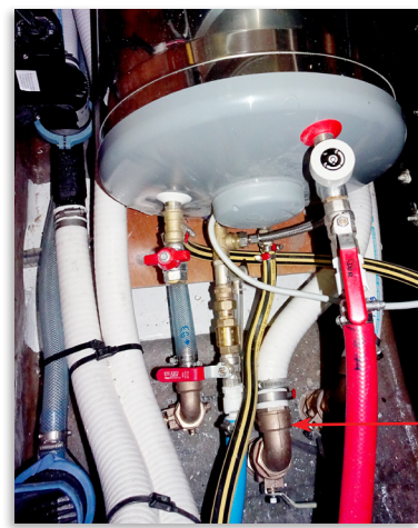
Vanne Passe-coque Réservoir Arrière Pompe 24V Décharge à la Mer Réservoir Arrière Évén Réservoir Arrière Nable de Vidange Réservoir Arrière via Station de Pompage Évacuation des Toilettes vers Réservoir Arrière Nable de Vidange Réservoir Avant via Station de Pompage Pompe 24V Décharge à la Mer Réservoir Avant Pompe Manuelle de Secours Réservoir Avant
