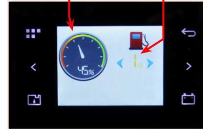
Niveau Réservoir Carburant 1 Identification du Réservoir
