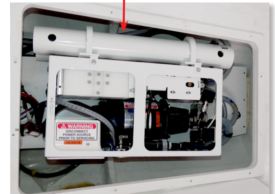
Dessalinisateur 24V, 90 litres/h Sous les Planchers
