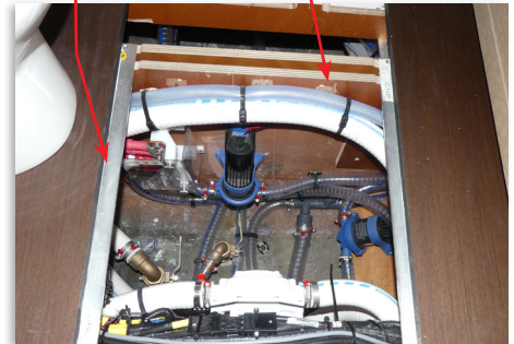
Pompe Aspiration Eaux Grises SdB Propriétaire (vers Vanne 3 Voies) Passe-coque & Vanne Rejet Mer Réservoir Arrière Vanne de Sélection 3 Voies SdB Propriétaire (Mer ou Réservoir) Nable de Vidange Réservoir Arrière via Station de Pompage Évén Réservoir Avant Nable de Vidange Réservoir Avant via Station de Pompage Pompe 24V Rejet Mer Réservoir Avant Vanne de Sélection 3 Voies Cabines Avant (Mer ou Réservoir) Pompe Aspiration Eaux Grises VIP (vers Vanne 3 Voies)
