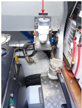
Filtre Racor Générateur TB
