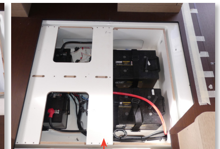
Groupe Batteries 420Ah = 4 x 12V-210Ah Batteries Gel Sous le Plancher Table a Cartes
