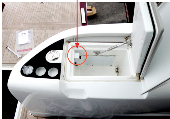
Compresseur 24V Glacière (Accès via S/M)
