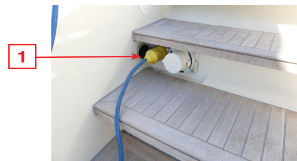
Sélecteur STANDARD S02 Quai 63A <> Générateur Tribord
