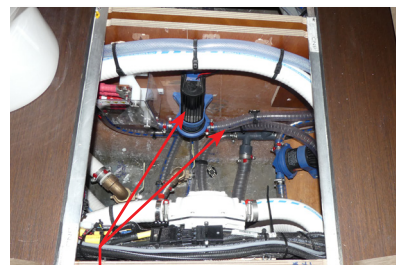
Réservoirs Eaux Grises et Noires à l'Avant, 135 litres Chacun
