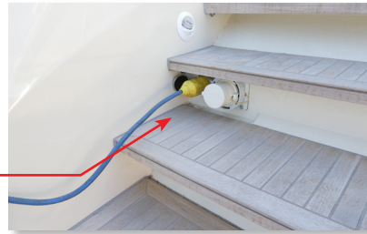
Disj. Diff. 63A/30mA Prise de Quai Standard Q10
