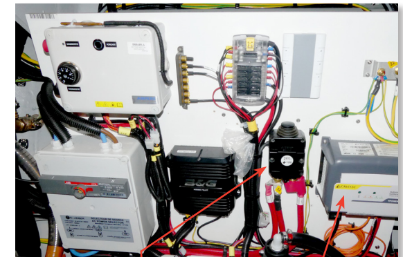
Coupe-batterie Moteur TB K23
