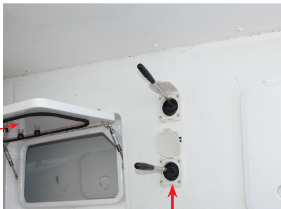
Poste de Pompage Manuel, sous la Banquette du Cockpit Arrière Tribord
